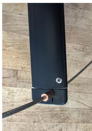
Insérez la pièce plastique solidaire du hauban dans le bout de la barre de flèche, le bloquer en vissant la vis parker qui se trouve à poste.
