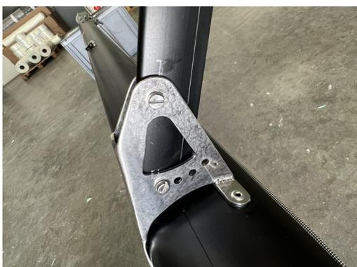
Fixez une barre de flèche de chaque côté du mât dans les ferrures prévues à cet effet (le profil le plus fin, le bord de fuite, vers l'arrière).
